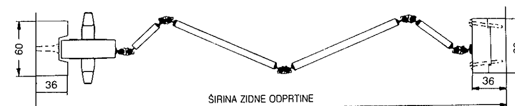
PREKLOPNA VRATA tip »PIOSTIL« – izven tipske dimenzije
